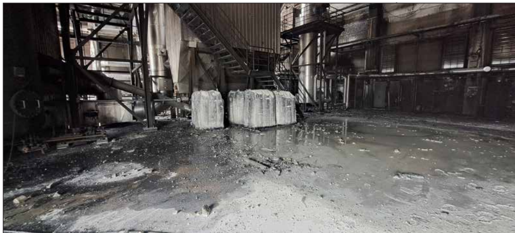
Fotografija 2: Posljedice požara – velika količina pepela, čađe i kontaminirane vode na podu
